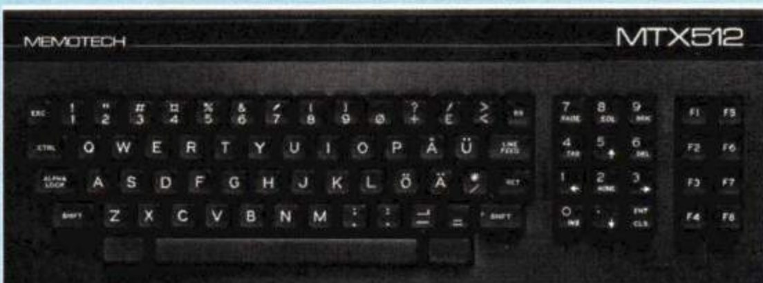
Näppäimistön kokonaiskuva. Kaksi merkittävää näppäintä aiheuttavat yhtäaikaan painettaessa virtakatkon. Funktionäp-
