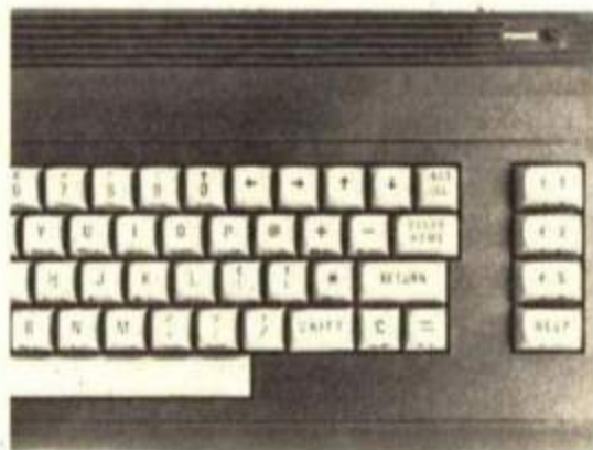
Kursorinäppäimet on uudessa mallissa siirretty epäkäytännöllisempään paikkaan näppäimistön oikeaan yläkulmaan.
