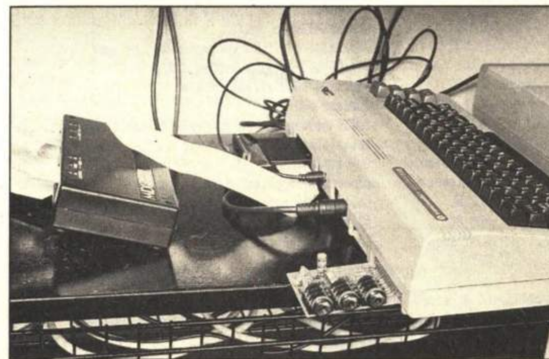
Kuusnelonen ohjaa koko systeemiä MIDI- ja synkronointiliitännän (moniraitanauhuria varten) avulla. Ohjelmina on MIDI-sekvensseri ja soundimuisti. Keikalla kappale ladataan levyiltä ja kuusnelonen ohjaa automaattisesti syntikkaa ja soittaa pohjan. Pohjan päälle soitetaan elävää musiikkia.
