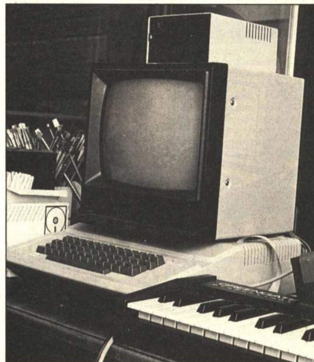
Apple II:een on liitetty Greengate DS-3 sampleri. Sillä voi digitoida ääniä ja soittaa niitä koskettimiston tai MIDI:n kautta. Muunmuassa Vakuutus on -kappaleen peltisoundi on tuotettu tällä. Soundi on varastettu Carl Orffin levyiltä.
