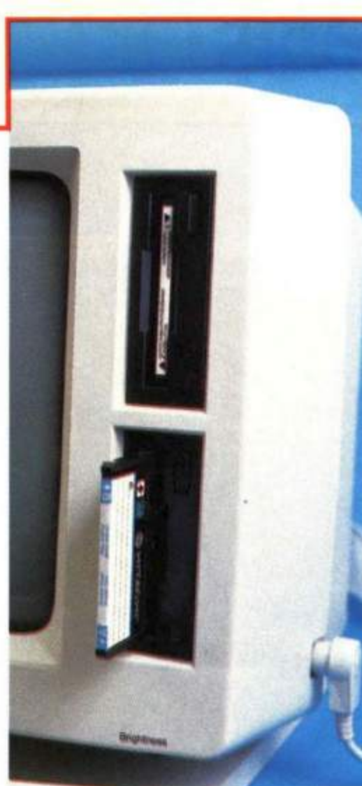
Amstrad PCW8512:n kaksi levyasemaa näkyvät päällekkäin sijoitettuna monitorin oikeassa etukulmassa. Kolmas levyasema on näkymättömissä koneen muistissa niin haluttaessa.
