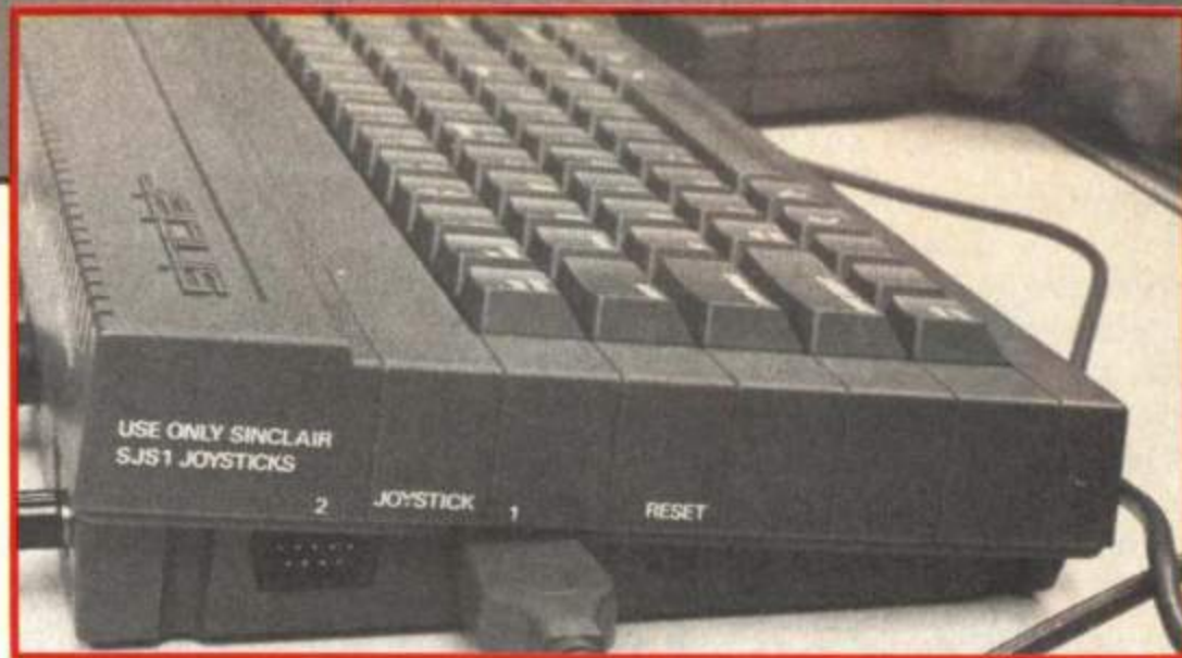
Kuva 1. Vihdoinkin ilotikkuportit. Mutta ei laite olisi Sinclair, jos portit olisivat täysin standardin mukaisia...
