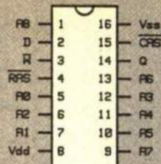
Kuva 1. Dynaamiset RAM-piirit 4164 (64 kt) ja 41256 (256 kt).
