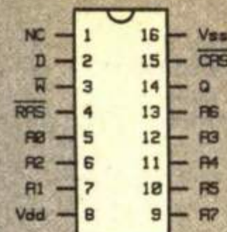
Kuva 1. Dynaamiset RAM-piirit 4164 (64 kt) ja 41256 (256 kt).
