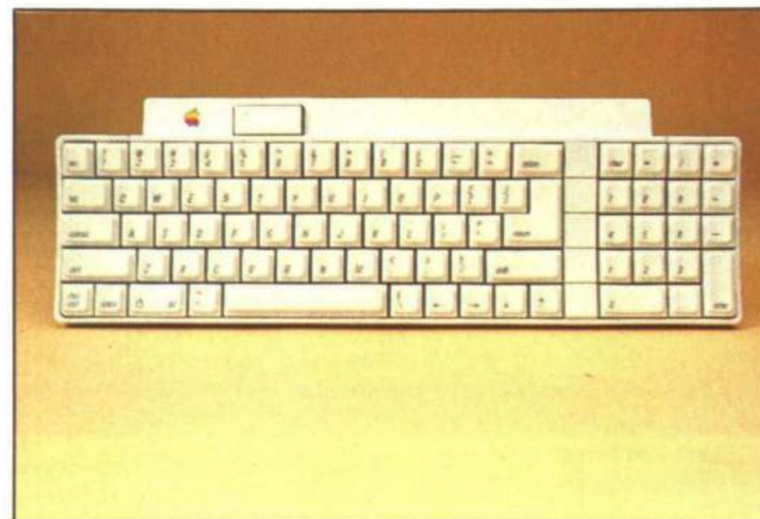
Kuva 2. 81 nappulan näppäimistö liitetään koneeseen kierrehjolla, joka venyy juuri puolitoistametriseksi.
