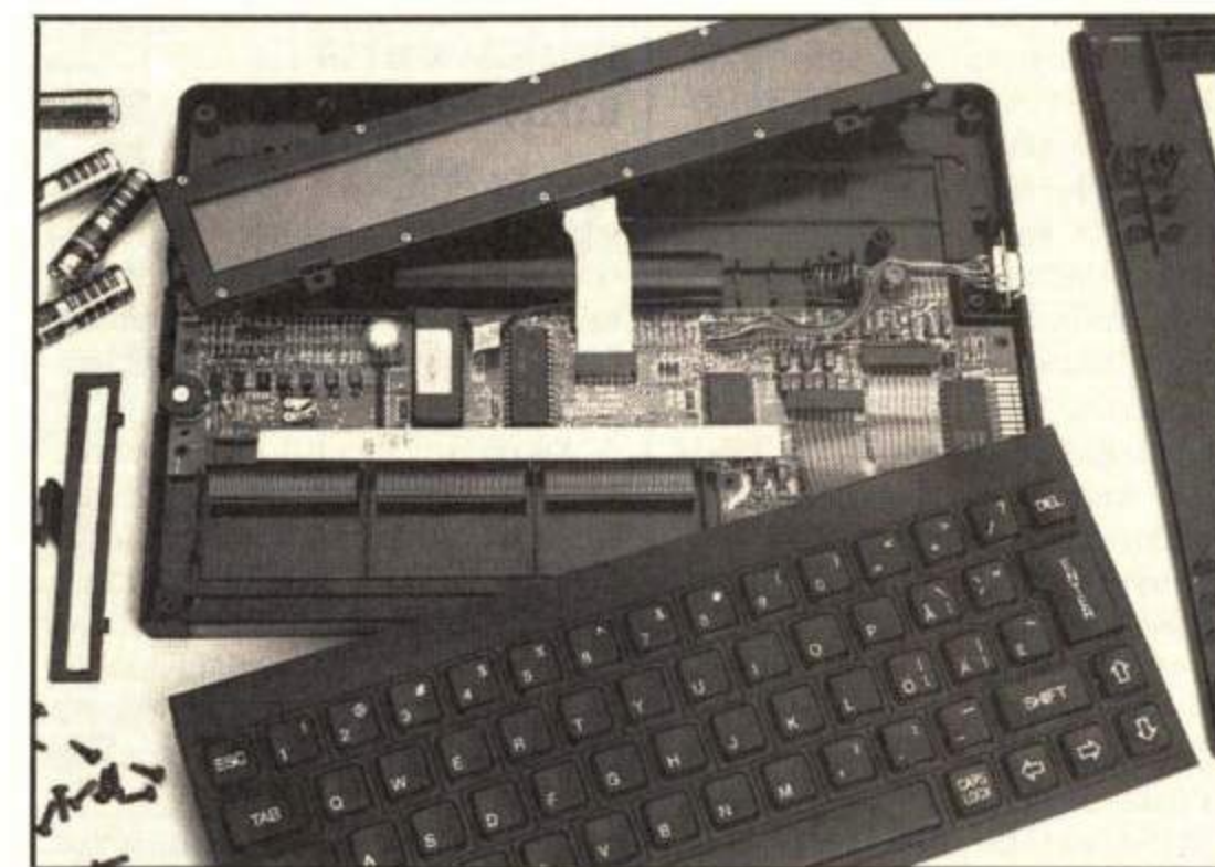
Epsonin valmistaman Supertwist LCD-näytön, näppäimistön, ja parinkymmenen pikkuosan lisäksi Z88 sisältää neljä mikropiiriä: Z80-prosessorin, 32 kt:n RAM-muistin, 128 kt:n ROMin, jossa on ohjelmisto, ja NECin varta vasten Z88:lle valmistaman muistinballin- ja I/O-piirin.
