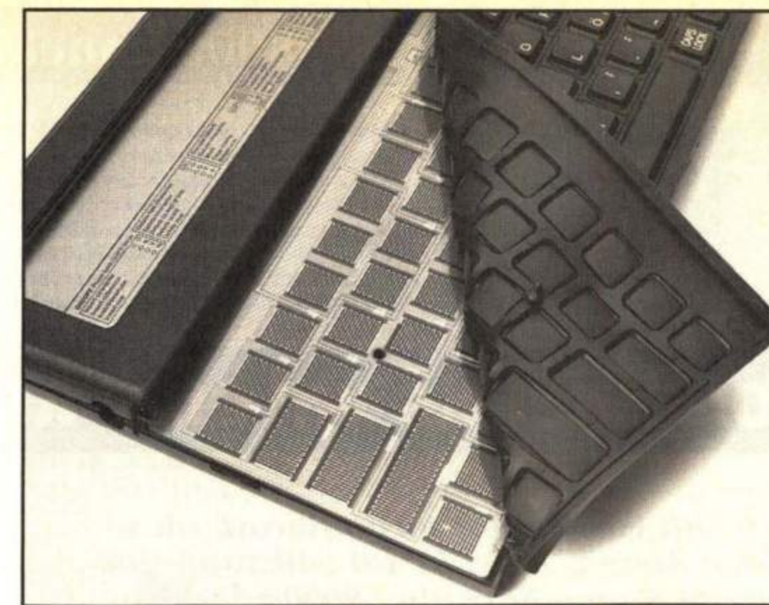
Kumimatto ja sen alla oleva filmi välittää näppäilyn keskusyksikölle. Yllättävän hyvä tuntuma on saatu aikaan näppäimen muotoilulla. Rakenteen ansiosta ei ole väliä mille kobtaa näppäintä painaa, toisin kuin Spectrumissa.
