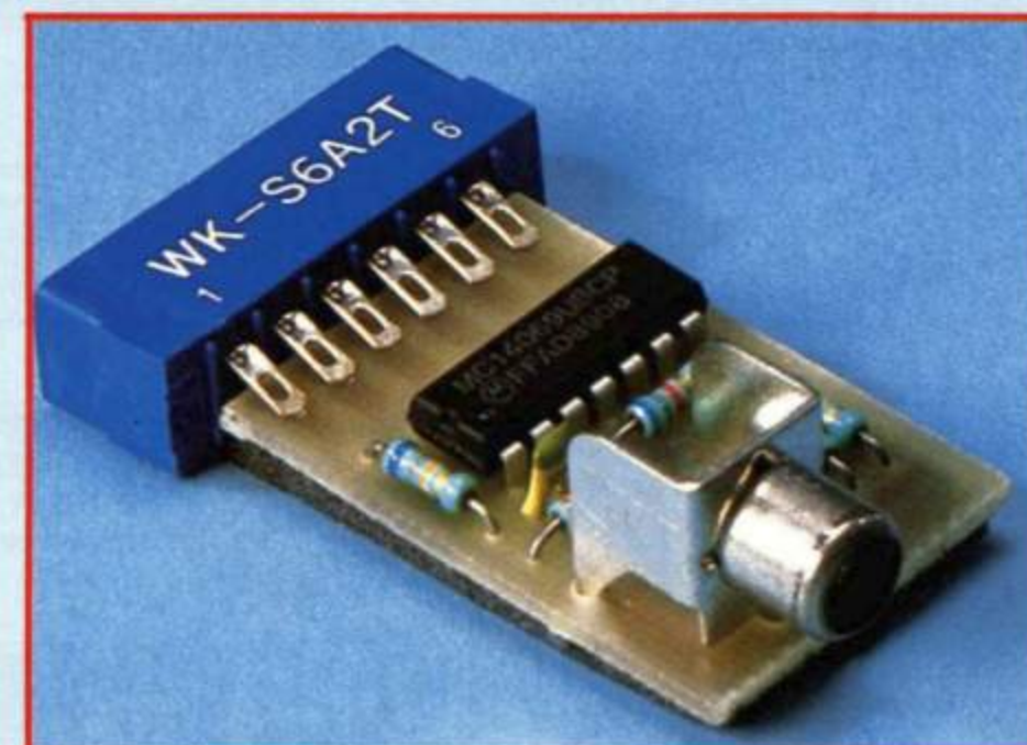
CD-levysoittimen ja välilijobdon lisäksi tarvitaan vain pieni kasettiporttiin liitettävä sovituskappale.
