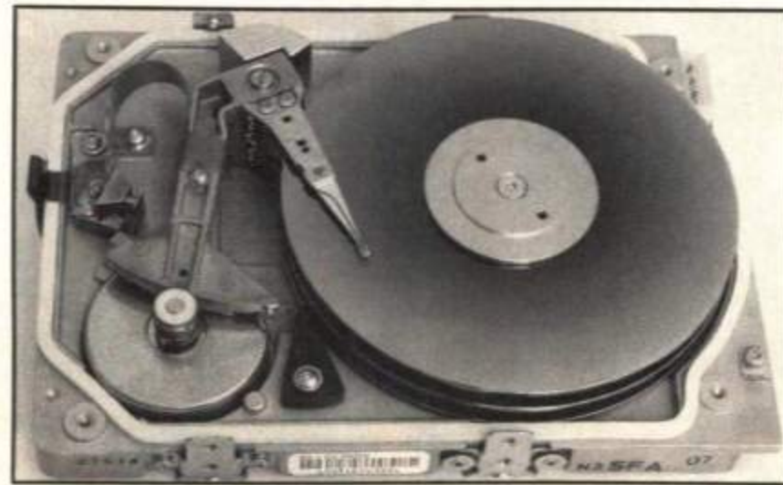
Lukupään etäisyys suurella nopeudella pyörivän levyn pinnasta on vain millimetrin osia. Pienetkin epäpuhtaudet ovat kobalokkaita, joten kiintolevyn ilmatiivistä koteloa ei missään tapauksessa pidä avata kotiloissa.
