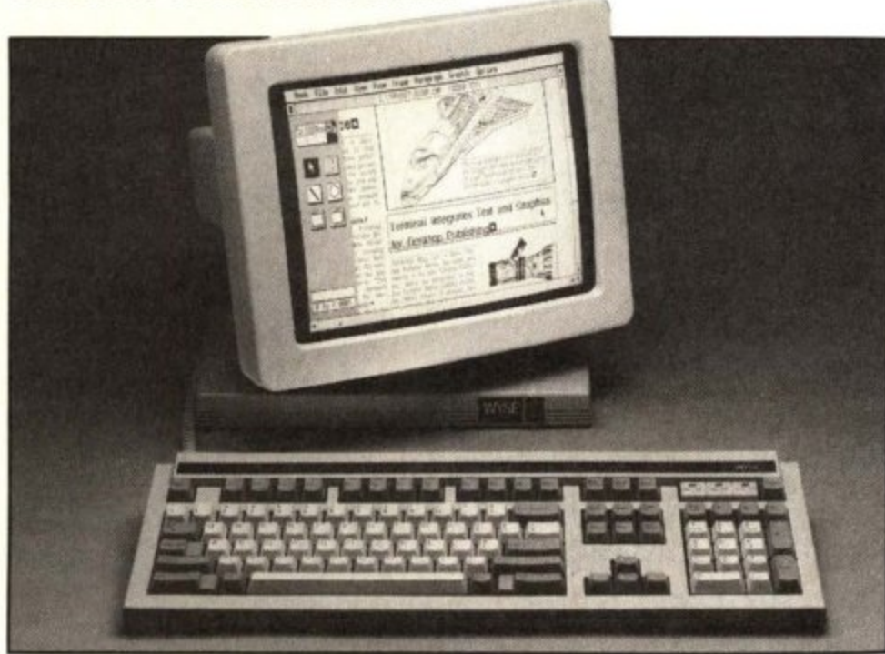
Ulkoisesti pääte muistuttaa PC:tä. Huomattavin ero on keskusyksikön puuttuminen.
