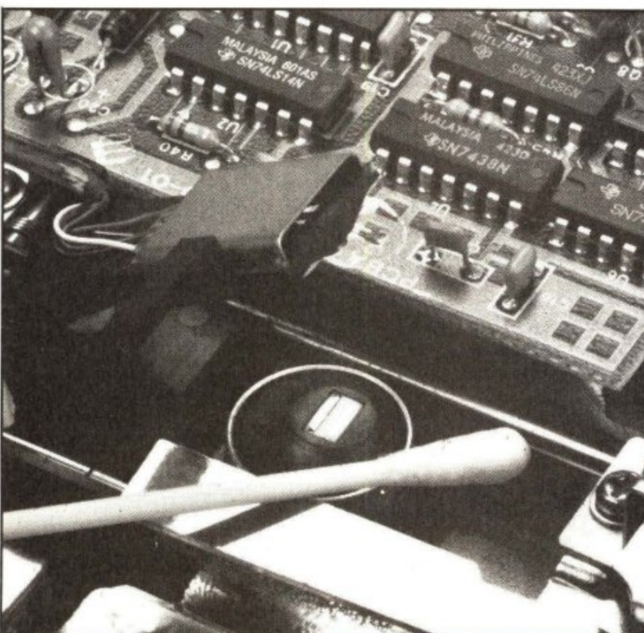
PC:n levyasema kirjoittaa tietoa vain 0.33 mm leveälle uralle. Pienetkin epäpuhtaudet levyn pinnassa voivat olla kohtalokkaita.
