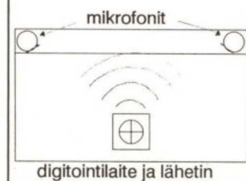
Kuvat 3a ja 3b. Digitointipöytä käytetään runsaasti CAD-ympäristöissä. Niiden avulla saadaan tarkasti selville, missä kohdassa osoitinlaite sijaitsee.
