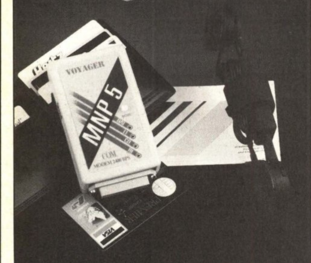
Voyagerin taskumodeemin varusteisiin kuuluu mikrofoni-kuulokkeiden yhdistelmä, jolloin laitetta voi käyttää myös akustisena modeemina.
