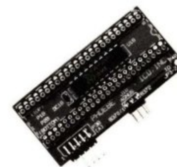
Kaksinumeroinen näyttö sopii mukavasti levyaseman etupaneeliin. Näytön saa myös irrallisena Amiga 2000:een.
