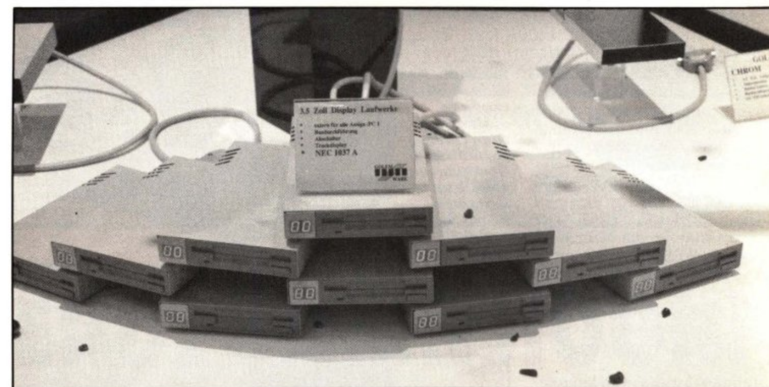
Kaksinumeroinen näyttö sopii mukavasti levyaseman etupaneeliin. Näytön saa myös irrallisena Amiga 2000:een.
