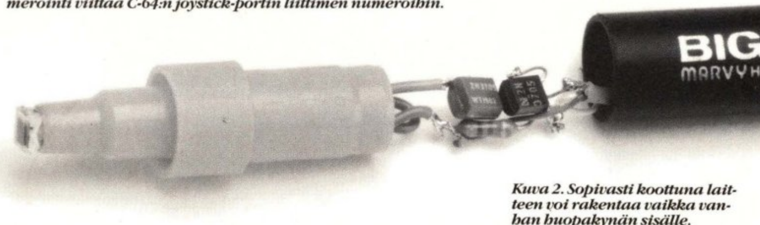
Kuva 1. Valokynä sisältää vain neljä komponenttia. Liitäntöjen numerointi viittaa C-64:n joystick-portin liittimen numeroihin.
