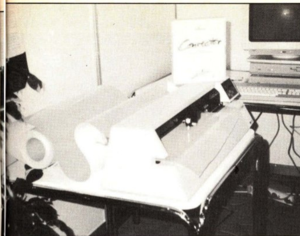
Cutter eli Cutting Plotter Roland Camm-1 leikkaa tarramuovia haluttuun muotoon esimerkiksi näyteikkunasomistuksiksi.
