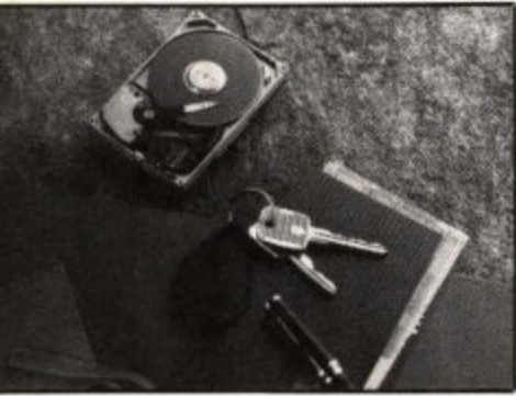
Go-Drive-kiintolevy on vain 2,5 tuumaa (6,25 cm) leveä.
