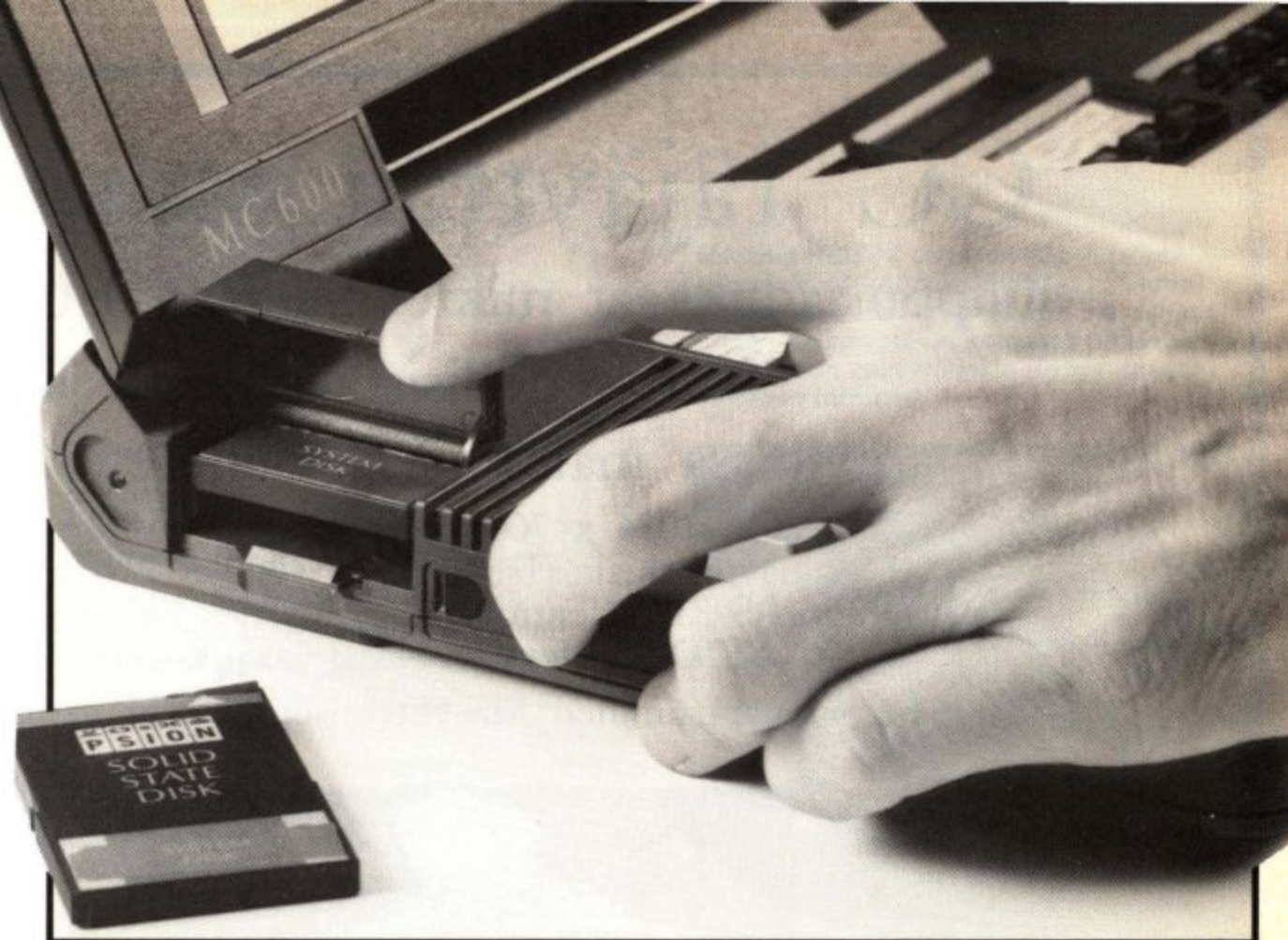
Yhtenä syynä Psionin pienen virrankulutukseen ovat tavallisuudesta poikkeavat massamuistit. Pienet, puolijohdemuisteja sisältävät kortit toimivat levyasemina.
