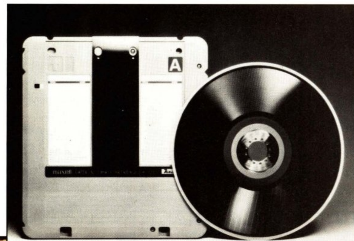
Tälle 12 tuuman WORM-levylle mahtuu kuusi miljoonaa A4-sivua tekstiä, joista saisi pinottuna yli kilometrin korkuisen tornin.
