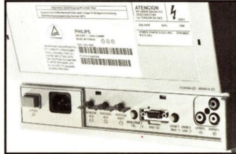
Takaseinistä monitorin tuntee. D9-liittimeen saadaan yhdistettyä niin analoginen kuin digitaalinen RGB-signaali. Oikeassa laidassa oleviin RCA-liittimiin saadaan video- ja audiosignaali. Vasemmalla puolella on kolme säädintä kuvan venyttelemiseksi ja paikan muuttamiseksi.
