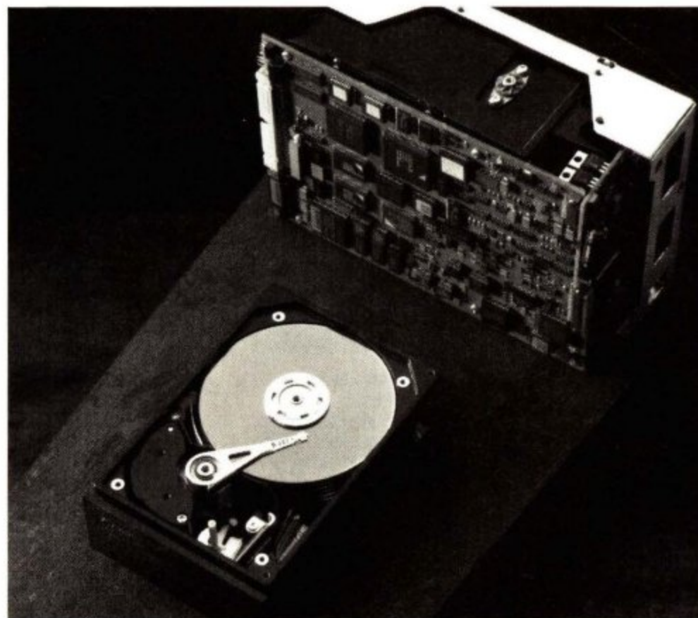
3,5-tuumaiseen kiintolevyyn on onnistuttu ahtamaan 1,2 gigatavua. Vielä muutama vuosi sitten gigainen kiintolevy oli ison tiiliskiven kokoinen.
