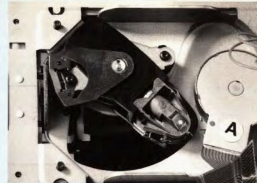
CDI 601:ssä on Philipsin uusi CD-koneisto CDM-9. Yhdysrakenteisen laser- ja valodiiodin ansiosta lukupään liikkuvien osien massa on entistä pienempi.
