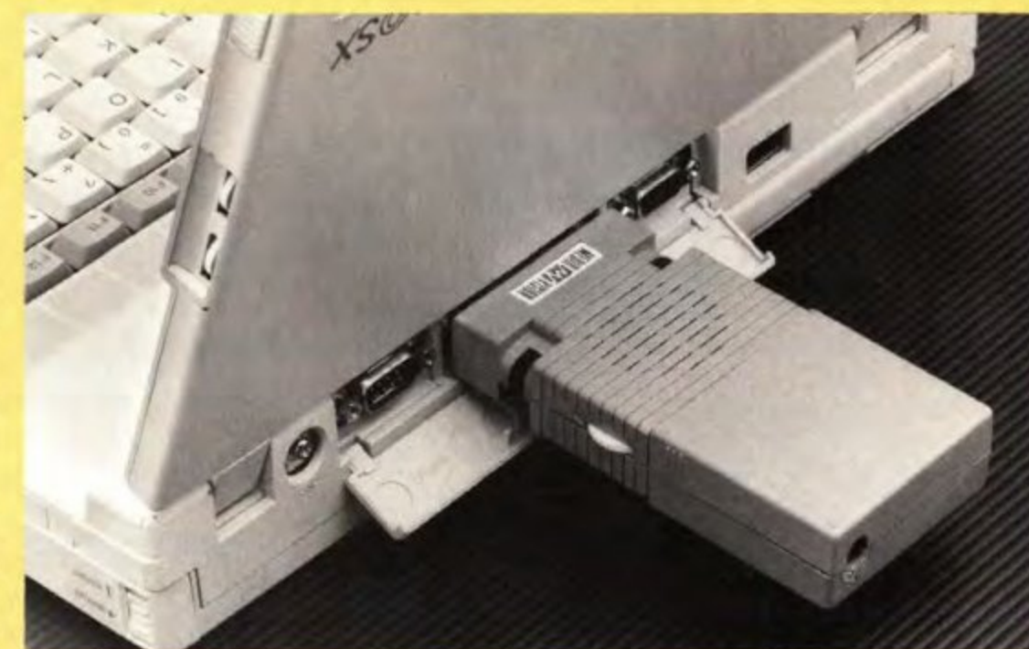
AudioPort kytke- tään mikron kirjoitin- porttiin. Väylä- riippumattomuus mahdollistaa kortin liittämisen kannet- taviin mikroihin.
