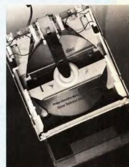
CDI 601:ssä on Philipsin uusi CD-koneisto CDM-9. Yhdysrakenteisen laser- ja valodiiodin ansiosta lukupään liikkuvien osien massa on entistä pienempi.
