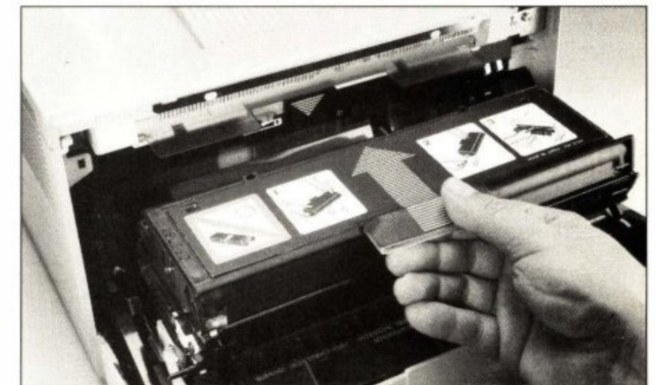
Canonissa on vain yksi kuluva osa, sillä väriainehie ja valoherkkää rumpu ovat yhdessä kasetissa. Kasetin vaihto on erittäin helppoa. Samalla tavalla toimivat Brother ja Star, jotka käyttävät samaa Canonin valmistamaa koneistoa.
