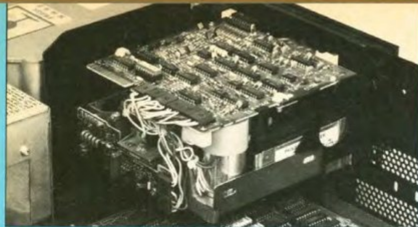
PC:n sisusta ilman laajennuskortteja ja kaapeleita. Puhdista ilmasuihkeella, puhaltamalla ja/tai minipölynimurilla.
